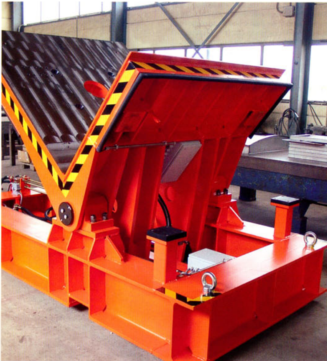
Dieser Ballenwender arbeitet mit einem elektromechanischen Antrieb.
