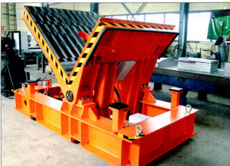
Mit einem Hydraulikgetriebe sind die Werkzeugwender von Wallraven ausgestattet, die bis zu 25 Tonnen schwere Produkte wenden können. Per Knopfdruck wird der Vorgang gestartet, der circa eine Minute dauert
